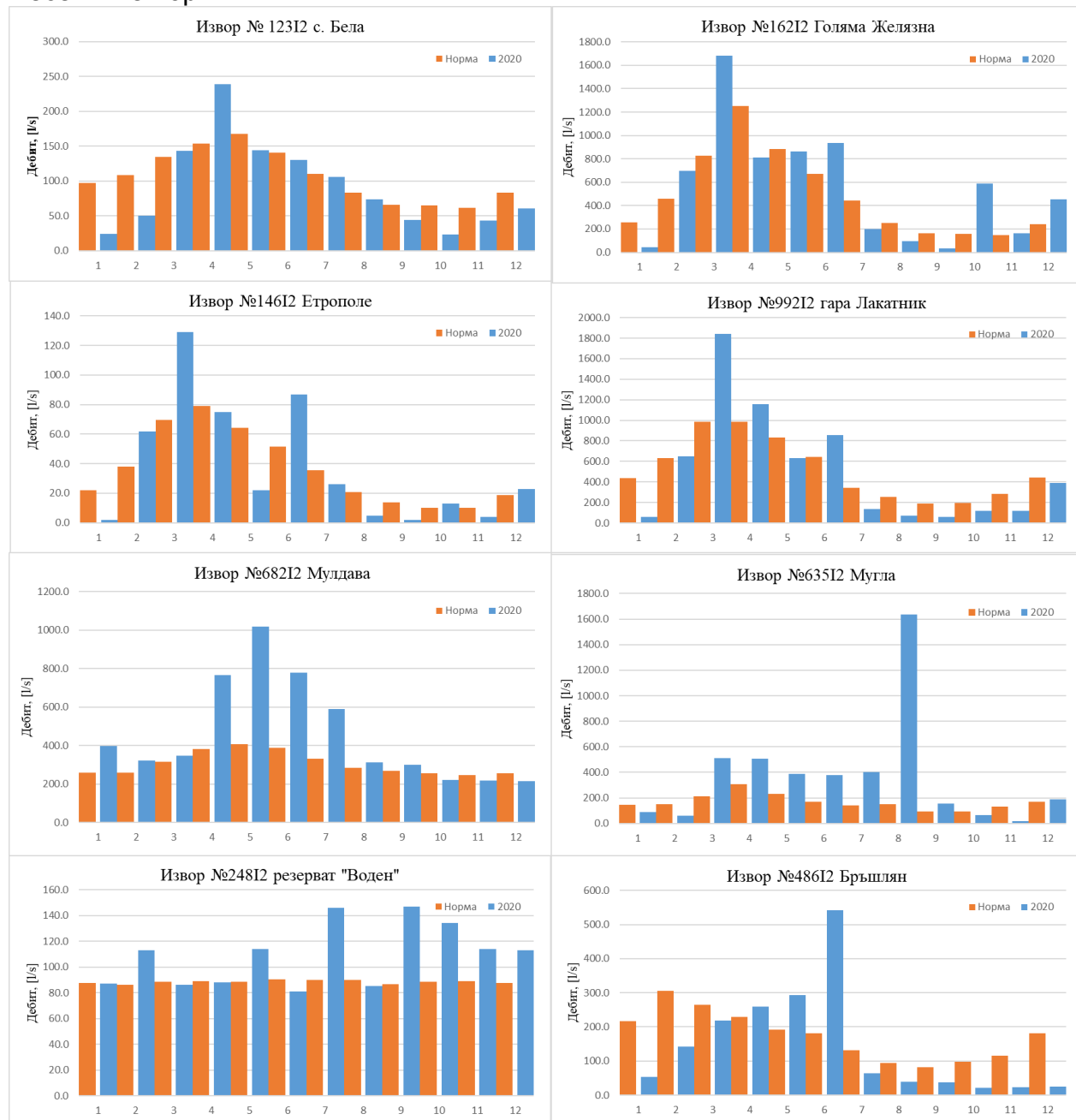
Фиг.1в. Максимални отклонения на средномесечните стойности на дебита, над месечните норми.
